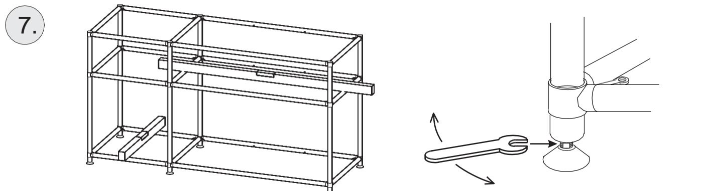
1. Breitenverbindung in Tiefenverbindung einschieben und eindrehen
