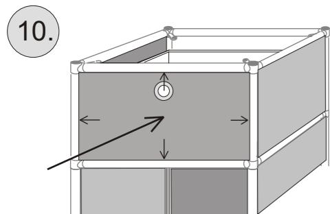
Schubkasten einschieben, gleichmäßig im Rohrrahmen justieren, dann herausziehen und Front jetzt fest verschrauben.
